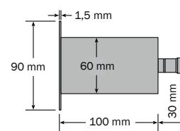
Anschluss für Leerrohr / Kabelverschraubung IP 68 intern
